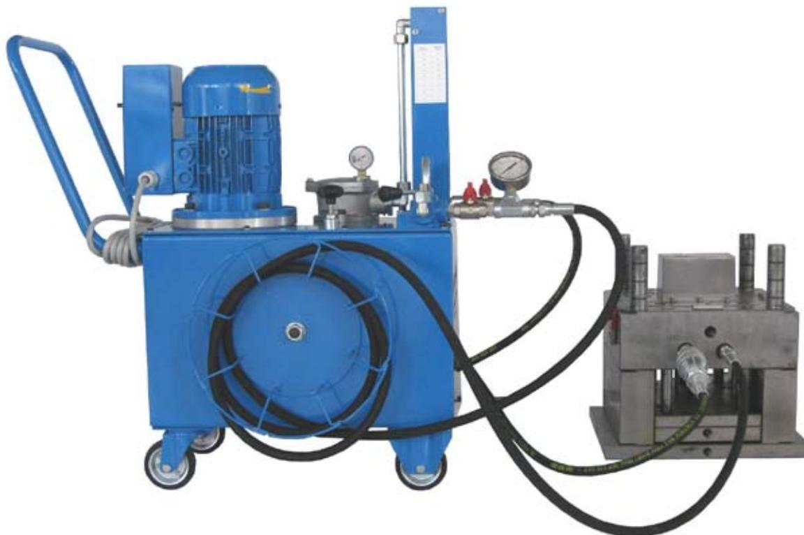
LA CENTRALITA **CPR** ES UN ACCESORIO INDISPENSABLE PARA LA PRUEBA FINAL DE LOS CIRCUITOS DE REFRIGERACIÓN.
