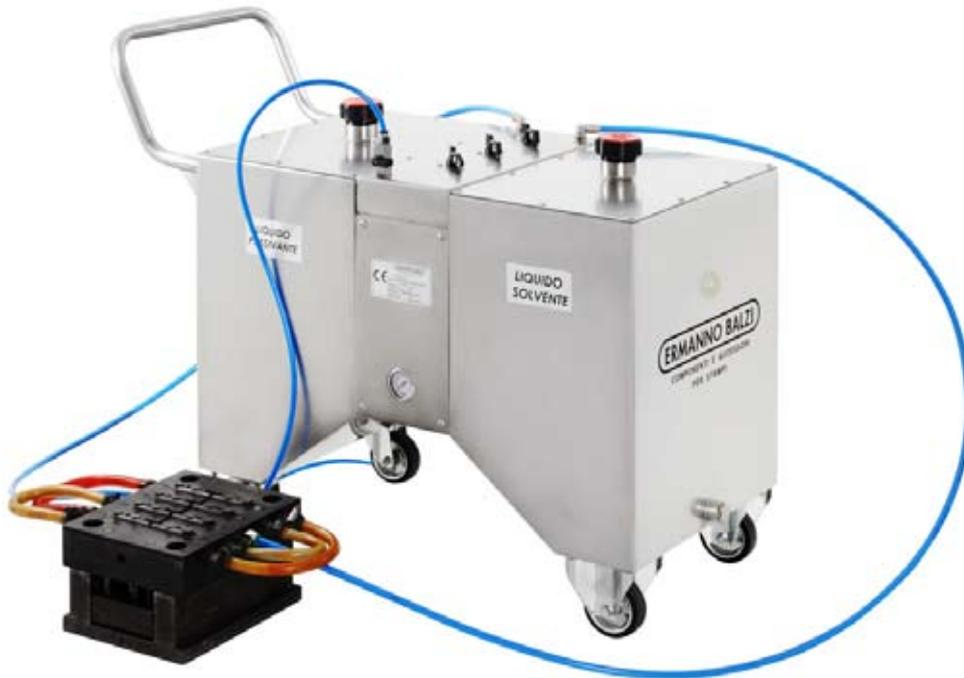
LA CENTRALITA **CDC** SIRVE PARA ELIMINAR DE LOS CIRCUITOS DE REFRIGERACIÓN DE LOS MOLDES TODOS AQUELLOS DEPÓSITOS CALCÁREOS U OTRAS IMPUREZAS QUE, ACUMULÁNDOSE EN EL TIEMPO, VAN A OBSTRUIR EL PASO DEL AGUA LIMITANDO LA CAPACIDAD DE ENFRIAMIENTO EN FASE DE MOLDEO.
